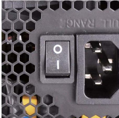
4. Desconecte el cable de CA de la fuente de alimentación.
