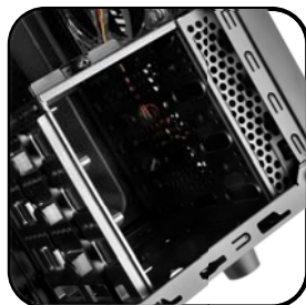
Tres bahías para unidades de 3.5" que no necesitan herramientas
