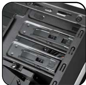
Dos bahías para unidades de 5.25" con seguros de activación manual
