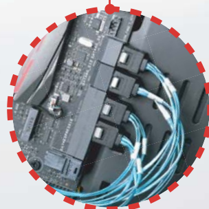
CPS03-REをマザーボードのSATAポートに接続します
