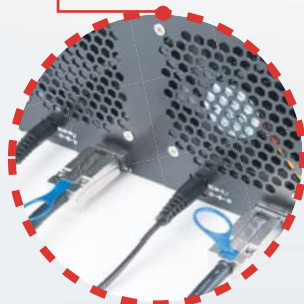
Mini-SAS SFF-8088および電源アダプタを外付けストレージに接続します
